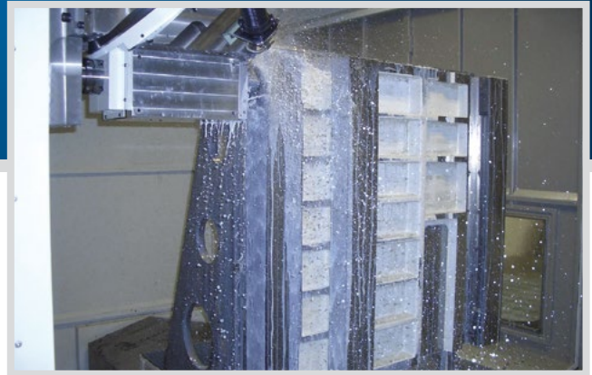
Bettsschlitten für eine Werkzeugmaschine wird auf dem BAZ fertig bearbeitet.
