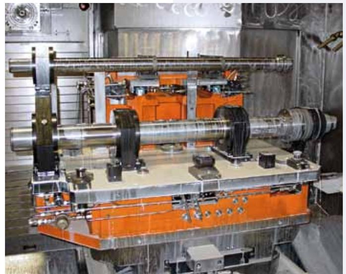
Das automatische Einwechseln von stabilen Bohrköpfen mit Winkelstellung und ca. 55 kg Gewicht aus dem Werkzeugmagazin und deren starre Aufnahme mittels einer hydraulischen Verriegelung an der Stirnseite der Spindel lässt die Einbringung der Stößelbohrungen in der gleichen Aufspannlage wie die der Zylinderbohrungen zu und führt damit zu engsten Toleranzen.
