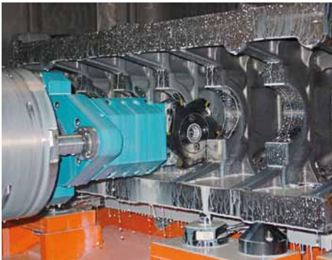
Das Fräsen der Zylinderkopffläche und das Spindeln der Zylinderbohrungen erfolgten im Originaleinbauszustand mit vertikaler Spindel. Somit ist eine Durchbiegung der schweren Zylinderbohrstangen durch ihr Eigengewicht absolut ausgeschlossen und die erreichte Genauigkeit ausschließlich von der Güte der Werkzeugvoreinstellung abhängig.
