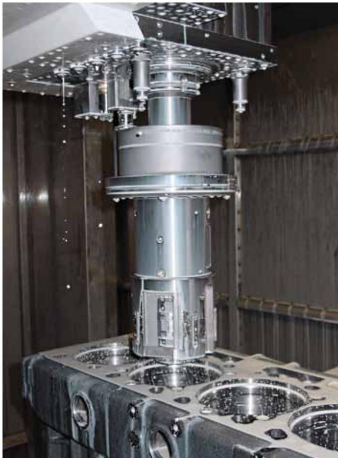
Im Rahmen der Kundenvorabnahme im Werk Reutlingen wurden insgesamt 80 Zylinderblöcke unter Produktionsbedingungen und mit anschließender Statistikauswertung gefertigt und einbaufertig nach China zurückgeliefert. Der Motor war ein Reihensechszylinder mit ca. 1 100 mm Länge und einem Einzelgewicht von ca. 300 kg. Ab Sommer 2005 wird dieser moderne Motor in Schwerlastkraftwagen für den chinesischen Markt eingesetzt und nach Europa an Hersteller solcher Fahrzeuge exportiert.
