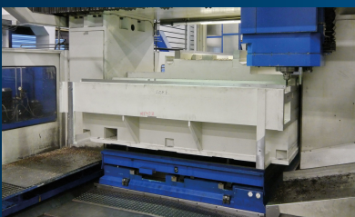
Maschinenunterteil Machine basement
