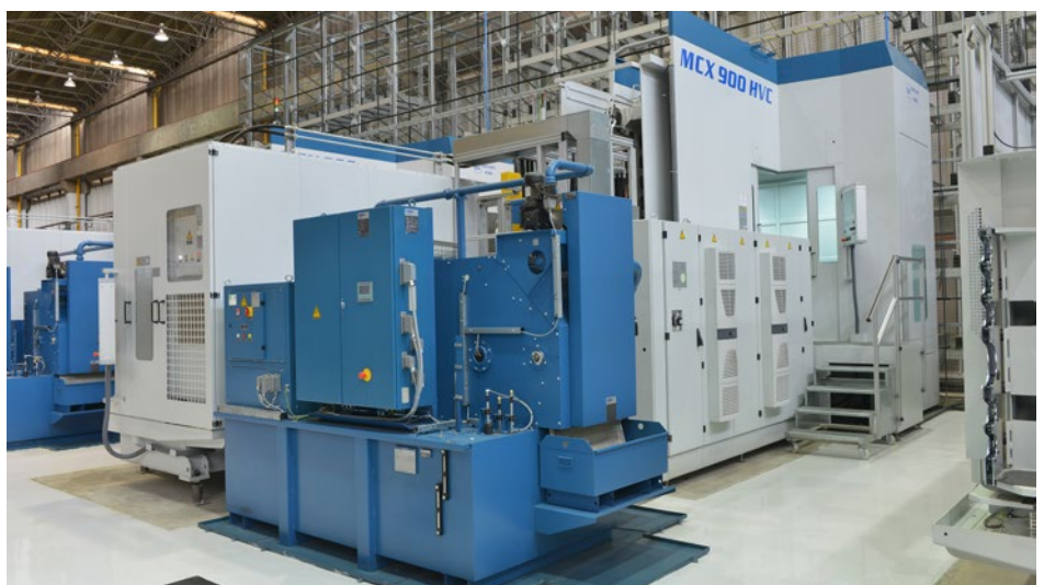
MCX 900 integriert in Fastems-Hochregalsystem
