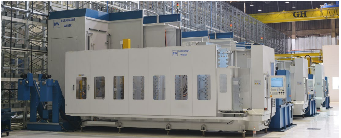
MCX mit Werkzeugspeicher für 450 Werkzeuge
