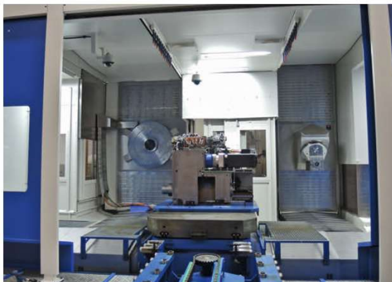
2 Einfahren des Verzahnungskopfes zum Austausch auf C-Achse; links Verzahnungsfrässtation, rechts HV-Spindel
