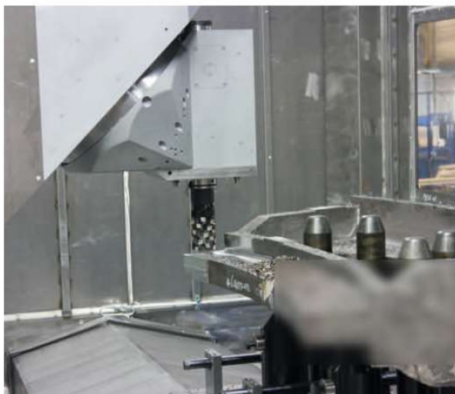
1 Horizontal-/Vertikalspindel aus dem Burkhardt+Weber-Standard
