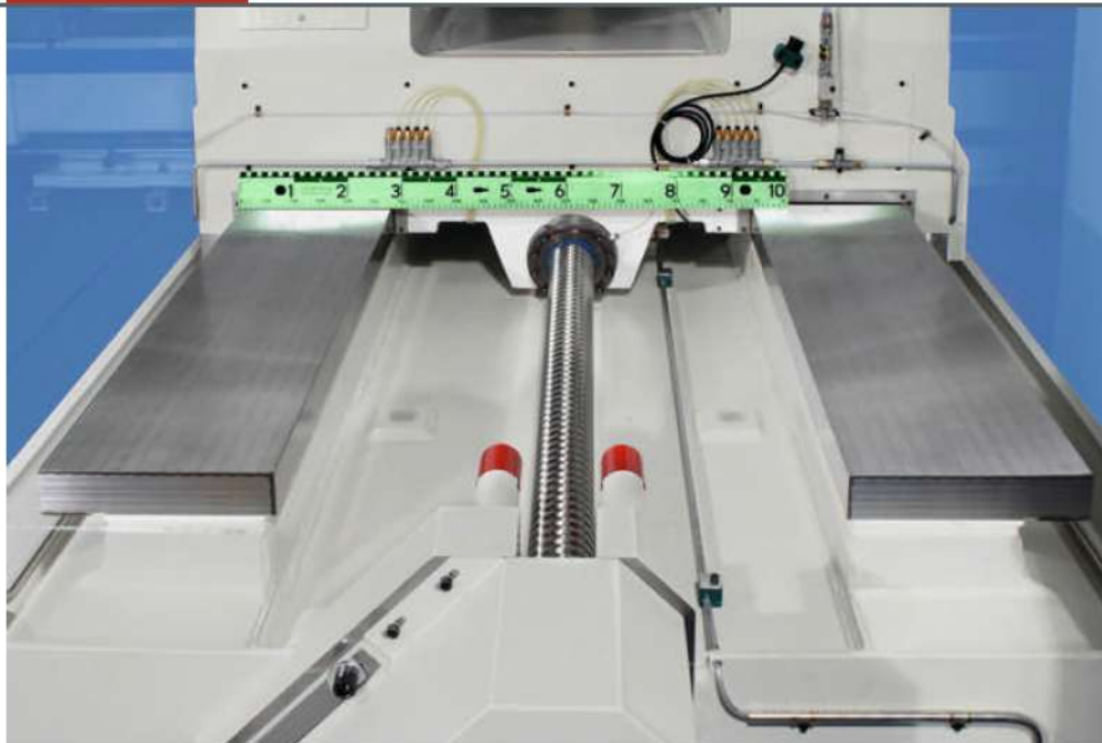
1 Lasergehärtete Flachführungen, hier Ständer-Achse, 255 mm breit
