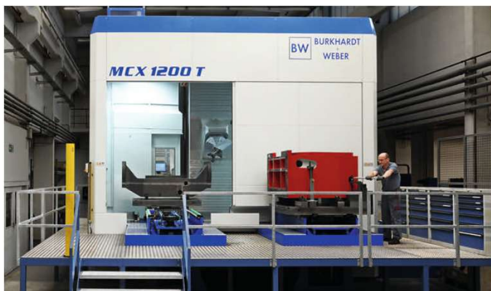
1 Liefert heute wirtschaftlich mit hoher Qualität bei Peiseler im Werk Remscheid ab: die MCX 1200 T von Burkhardt+Weber, ausgerüstet mit Torquetischen der ATD-Reihe
