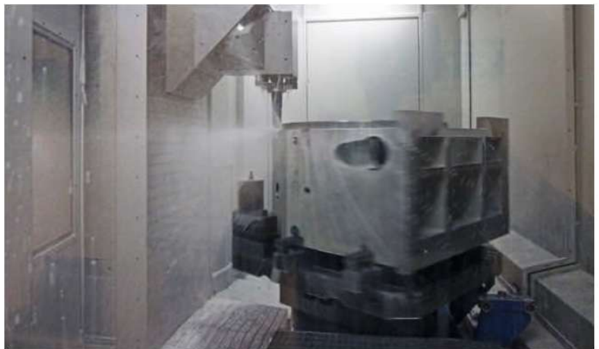
3 Ausdrehen eines Wendespannergehäuses
