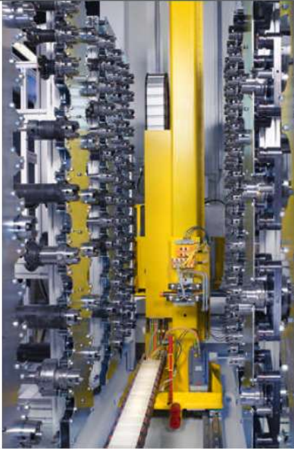
2 In der Maschinenausführung für Peiseler nimmt das Werkzeugmagazin 240 Werkzeuge mit bis zu 1000 mm Länge und 60 kg Gewicht auf
