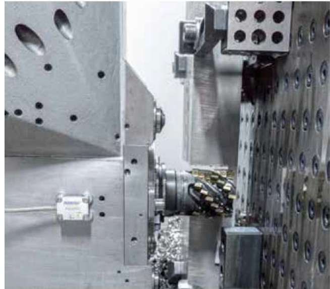
3 Im Rahmen von Versuchen zum Einbringen von Vollnuten mit einem fünfschneidigen 80-mm-Igelfräser ergaben sich Zerspanprozesse mit kaum messbaren Vibrationen [© Burkhardt+Weber]
