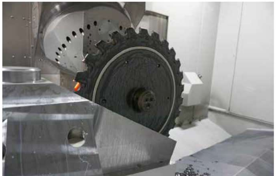
1 Schwerzerspanung in Aktion: Ein 600-mm-Scheibenfräser arbeitet am HVC-Kopf eines Bearbeitungszentrums von Burkhardt+Weber. Das Werkzeug verlangt der Maschine ein immens hohes Drehmoment im untersten Drehzahlbereich ab (© Burkhardt+Weber)
