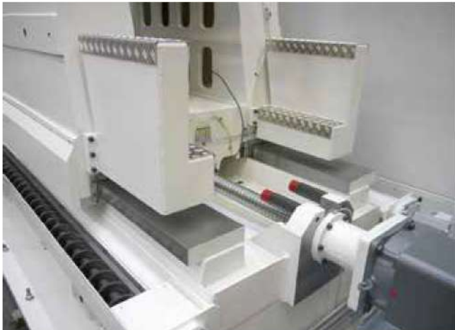
2 Z-Achse und Ständer eines flachgeführten Bearbeitungszentrums. Die besonders kräftige Dimensionierung der Komponenten soll Vibrationen im Gesamtsystem eliminieren [© Burkhardt+Weber]
