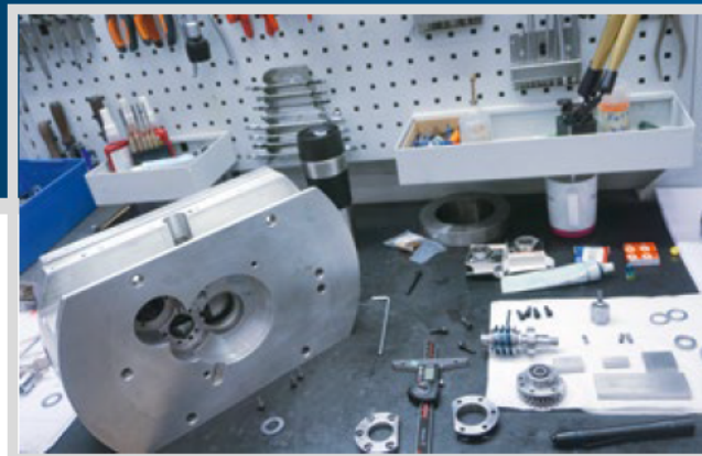
REPARATURARBEITEN AN EINEM PLANDREHKOPF.
