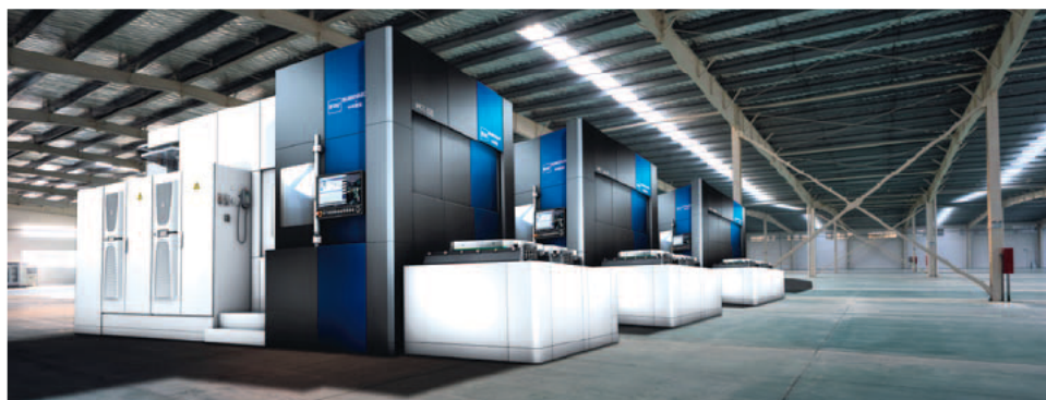
Die neue Baureihe MCC wurde als Serienmaschine entwickelt und weist von vorneherein alle Features auf, die für ihren typischen Einsatz notwendig sind. Die bewährte Bauweise von BW wurde von den großen BAZ übernommen und machen die MCC zu einer echten Burkhardt+Weber-Maschine.
