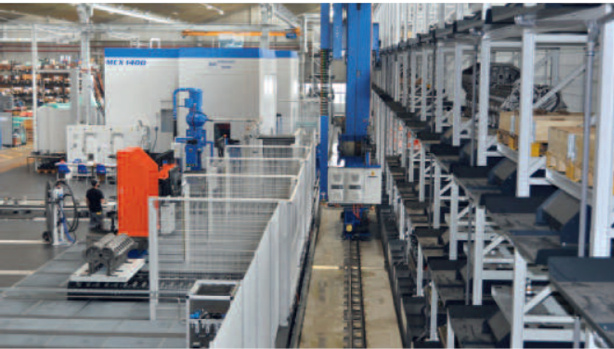
Das Palettenhandhabungssystem PHS 10 000 von Liebherr wurde speziell für Großteile entwickelt.
