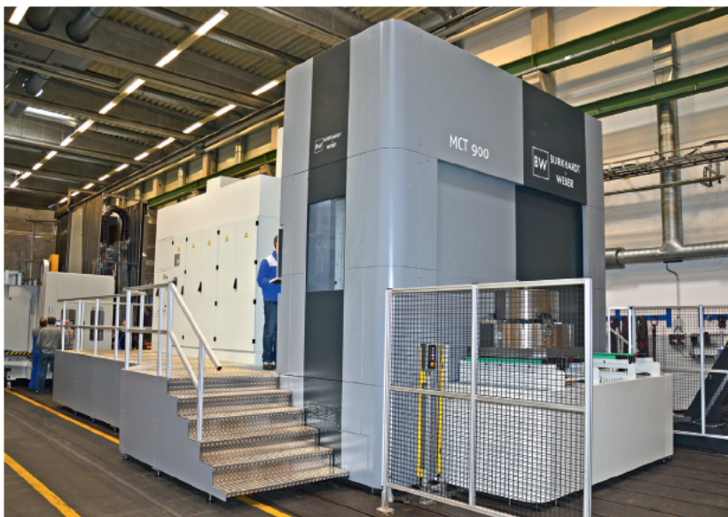
1 Technologieintegration von Fräsen, Bohren und Drehen in einem leistungsstarken 5-Achs-Getriebezentrums: das neue Fräsdrehzentrum MCT 900 von Burkhardt + Weber
