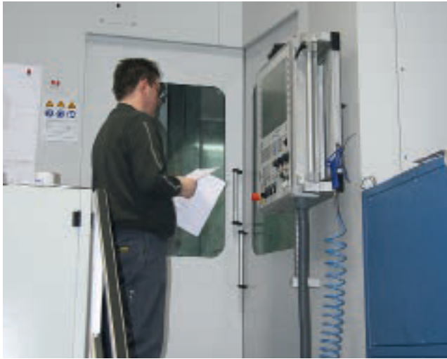
An die MCX 900 \mu ist - wie an alle Maschinen der Baureihe MCX - eine Sinumerik 840 D sl adaptiert.
