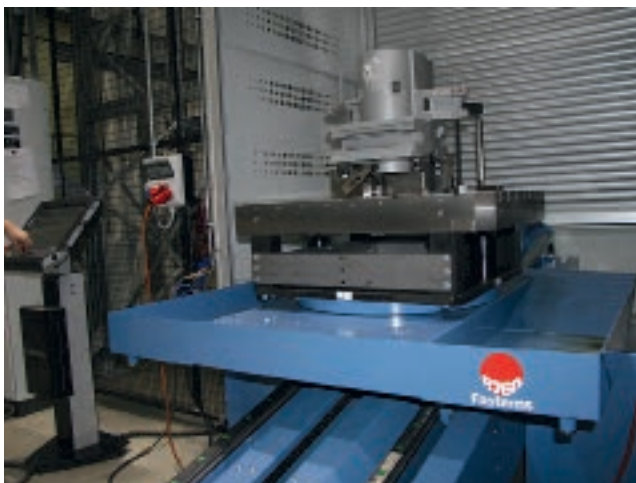
Rüststation des Fastems MLS-HD-System, das in der Endausstufe insgesamt fünf Bearbeitungszentren mit Teilen versorgt.
