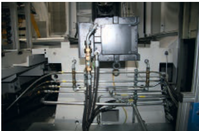
Gut zu sehen ist hier ein Teil der Wasserversorgung für die eingegossenen Wasserkreisläufe, die die Temperaturstabilisierung der Hauptachsen sicherstellen.
