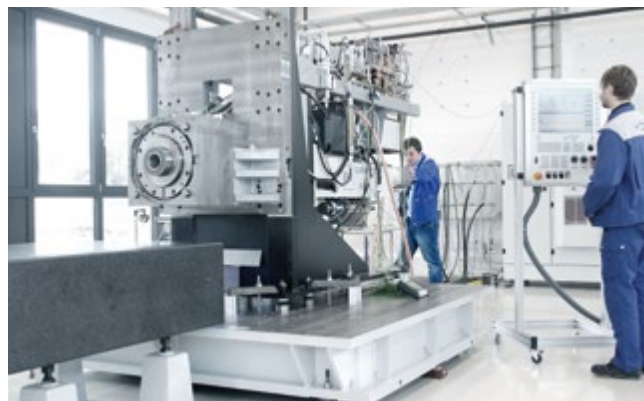
D160 Pinoleneinheit auf Prüfstand.
