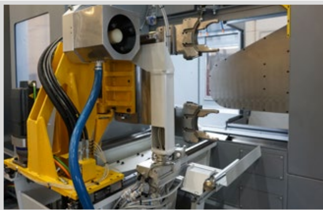
Konusreinigung und Bohrerbruchkontrolle.
