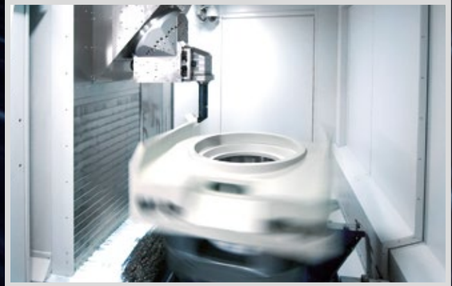
Kräftig dimensionierte Schwenkspindel mit Drehstahlhalter in 4-Punktklemmung. Automatischer Wechsel aller Drehwerkzeuge aus dem Standardmagazin.
