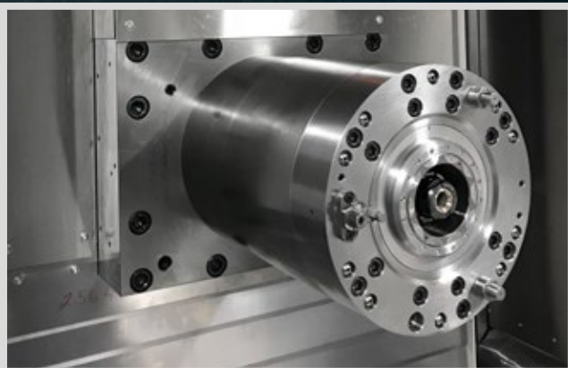
Kraftvolle horizontale Getriebespindel für die kompromisslose Zerspanung.
