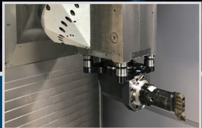
Drehwerkzeughalter aufgenommen an hydraulischer 4-Punktklemmung.
