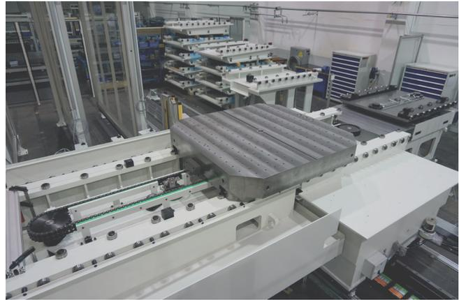
Übergabe einer Werkstückpalette von der Rüststation an das Palettentransportfahrzeug
