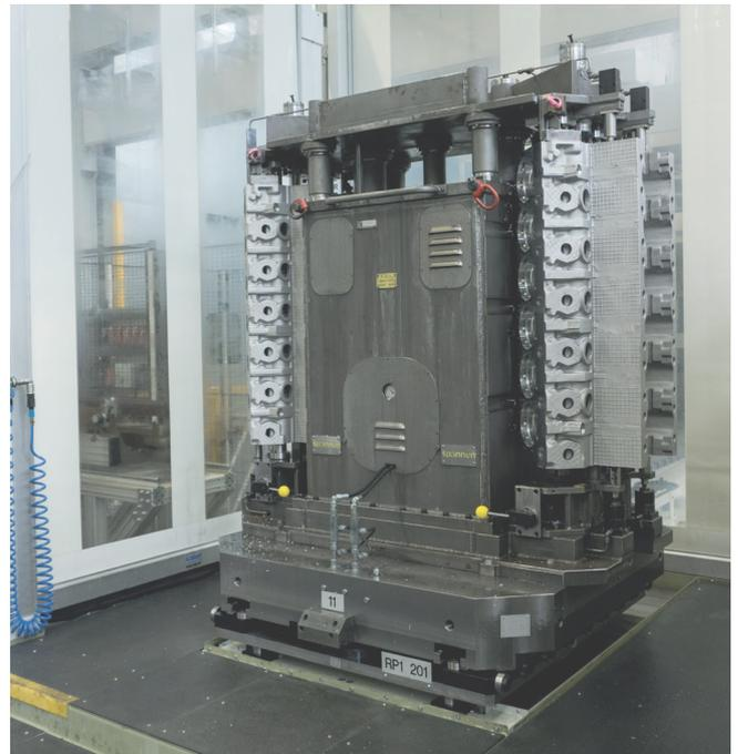
Rüststation mit Vorrichtung und Werkstücken, zusätzlich können Bohrstangen eingeschoben werden.
