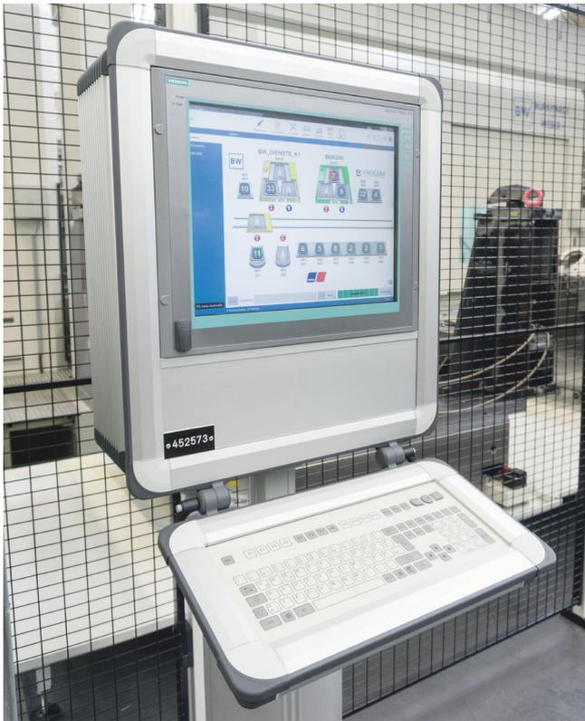
Der intuitiv zu bedienende Leitstand ermöglicht u.a. die Auftragsplanung, NC- Programmverwaltung sowie die Erfassung des Anlagenzustandes.
