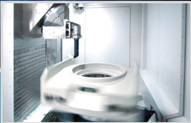
Kräftig dimensionierte Schwenkspindel mit Drehstahlhalter in 4-fach-Klemmung. Automatischer Wechsel aller Drehwerkzeuge aus dem Standardmagazin.
