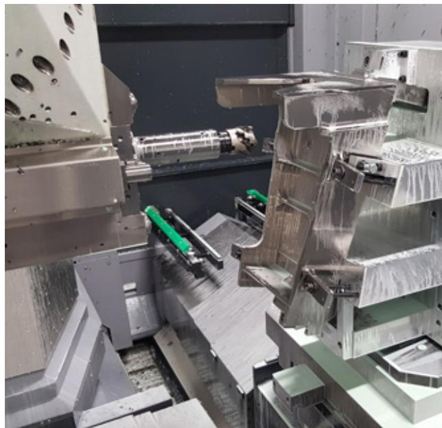
Struktur-Flügelteil für einen Business Jet aus einem Titanschmiedeteil der Firma voestalpine BÖHLER Aerospace GmbH & Co KG.
