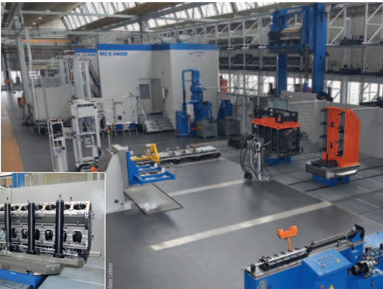
gung kombiniert werden. Der Wunsch: eine Komplettbearbeitung der komplexen Motoren innerhalb eines voll automatisierten Fertigungssystems.
