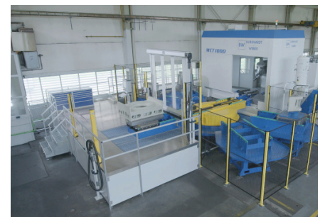
Alle Paletten werden bei BW gefertigt. Standard ist der 2-fach-Palettenwechsler. In der ausgebauten Variante sind sechs Paletten im Umlauf.
