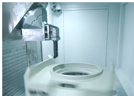
Beim Maschinencheck wurden an einem Grauguss-Tischgehäuse Dreh- und Fräsoperationen gefahren. Der steife Drehwerkzeughalter gewährleistet einen stabilen Schnitt (Zerspanparameter beim Drehen: v_1 = 0,6 mm/Umdrehung; v_2 = 200 m/min; a_p = 6 mm).
