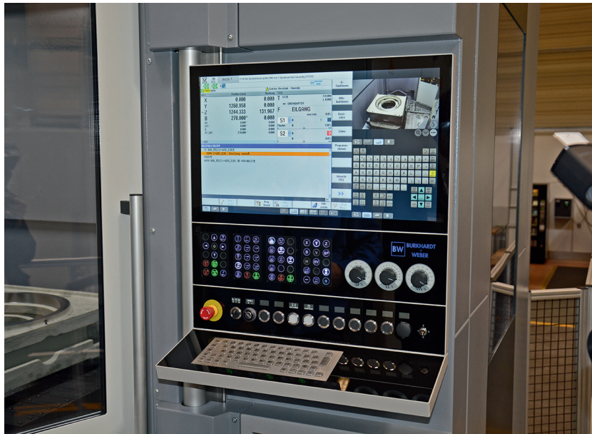
3 Soll neue Maßstäbe im Bedienkomfort setzen: das neue 24"-Smartpanel für die intuitive Maschinenbedienung (Bild: Hanser)
