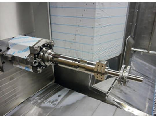
4 Sonderbohrstange mit doppeltem Planzug und Stützlager
