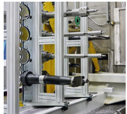
6 Sonderbohrstangen im BW-Regalmagazin
