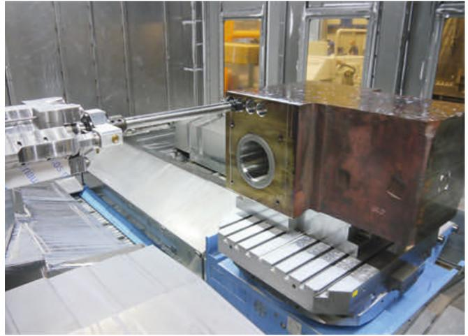
3 Ejektor-Bohrwerkzeug beim Probebohren
