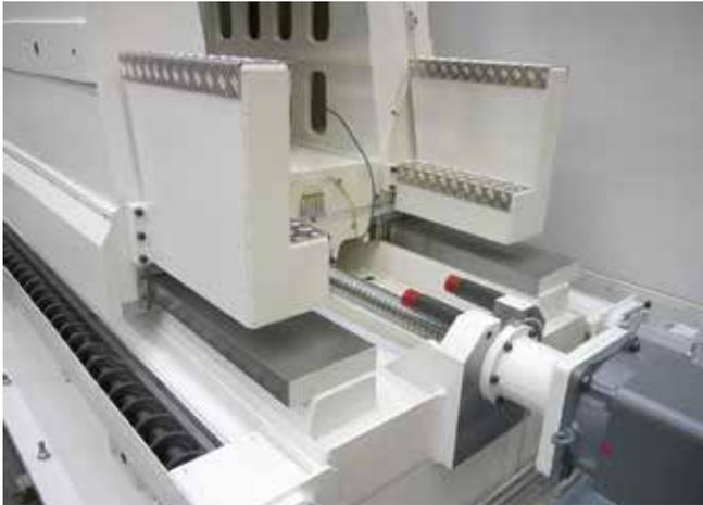
**2** Z-Achse und Ständer eines flachgeführten Bearbeitungszen-trums. Die besonders kräftige Dimensionierung der Komponenten soll Vibrationen im Gesamtsystem eliminieren (© Burkhardt+Weber)
