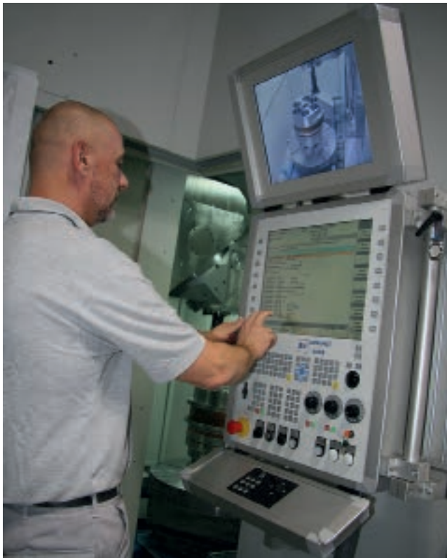
An den Steuerständen der beiden MCX-Zentren kann der Fortgang der Bearbeitungen auch am Bildschirm mitverfolgt werden.
