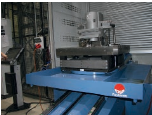
Rüststation des Fastems MLS-HD-System, das in der Endausstufe insgesamt fünf Bearbeitungszentren mit Teilen versorgt.
