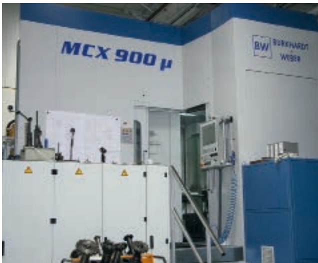
Trotz großer Abmaße und enormer Genauigkeitsanforderungen wollte man ein eigensteifes Maschinenbett, das anstelle eines Fundamentes mit einer betonierten Bodenplatte auskommt.
