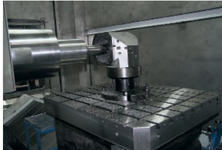
Anspruchsvolle Vorgaben: Kleiner 5 \mu m für die Geradlinigkeit auf einer Länge von 1.600 mm, bei der Rechtwinkligkeit auf 1.000 mm.
