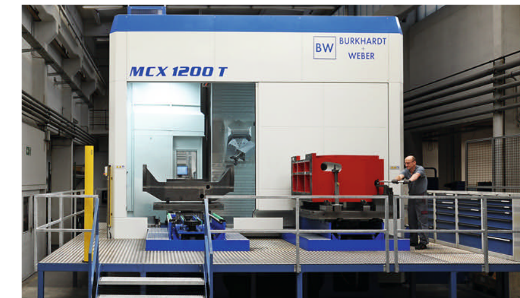
1 Liefert heute wirtschaftlich mit hoher Qualität bei Peiseler im Werk Remscheid ab: die MCX 1200 T von Burkhardt+Weber, ausgerüstet mit Torquetischen der ATD-Reihe
