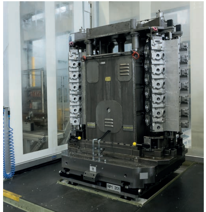
Rüststation mit Vorrichtung und Werkstücken, zusätzlich können Bohrstangen eingeschoben werden.
