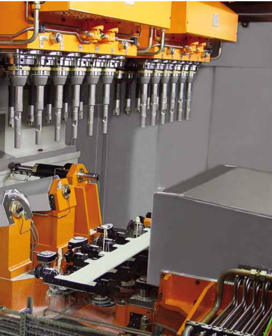
Spezialmaschine zur Bearbeitung von Zylinderbohrungen.
