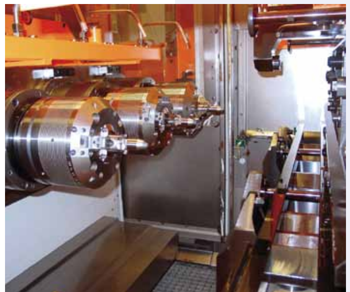
Dreispendlige Bearbeitungseinheit für Ventilsitz- und Ventilschaftbearbeitung.
