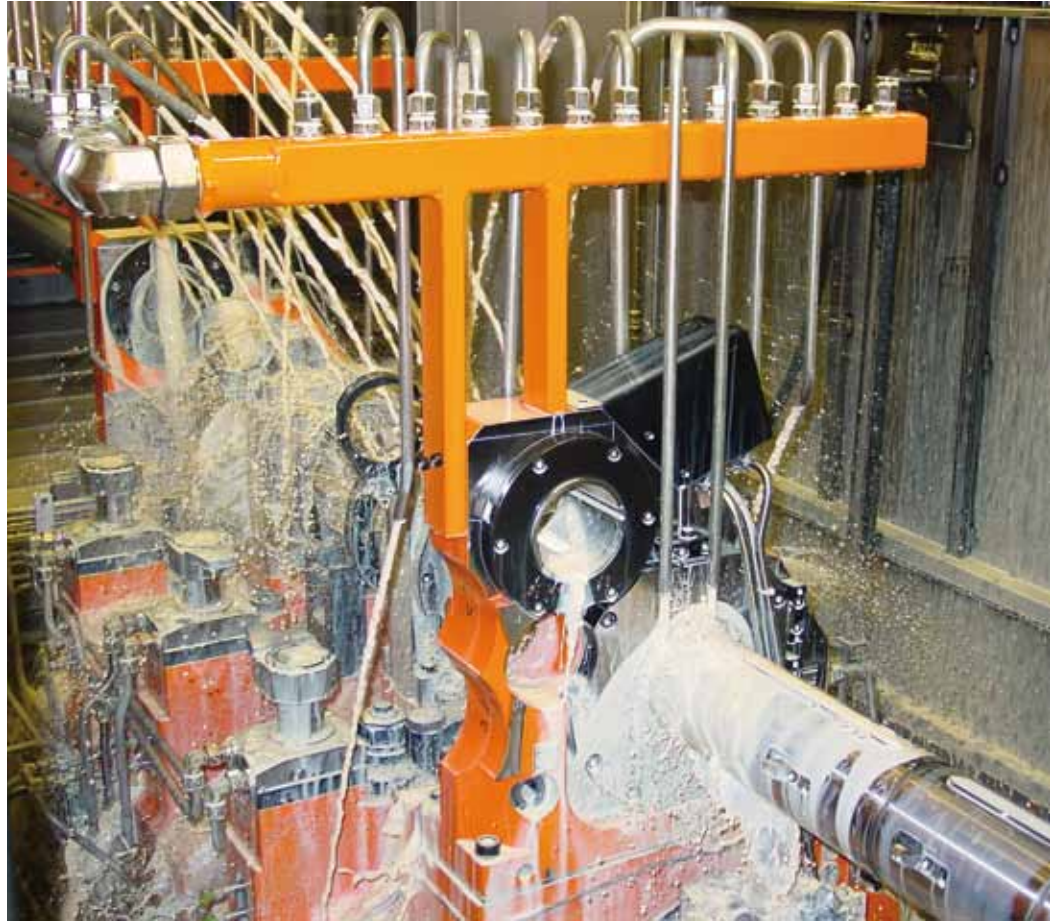
Bearbeitung einer Kurbelwellenbohrung mittels Reihenbohrstange.
